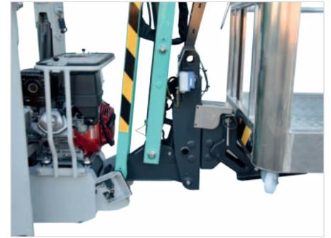
Compattezza del gruppo jib che ospita la cella di carico e sistema di montaggio rapido del cestello.
